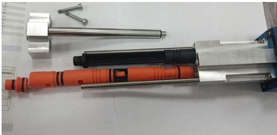
四、ATS型材装有真空发生器的那一端用干净布蘸取酒精擦拭（严重污染也可放入清水浸泡），并且清理海绵吸盘型腔内部灰尘等杂物。
